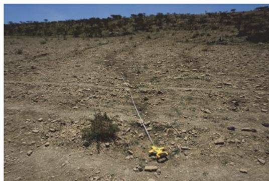
写真1 アディザボイ小流域上流のコムギ畑で発生したリル侵食
