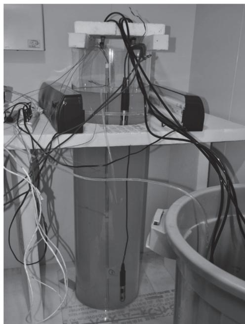
図 1 冷水散水実験装置
