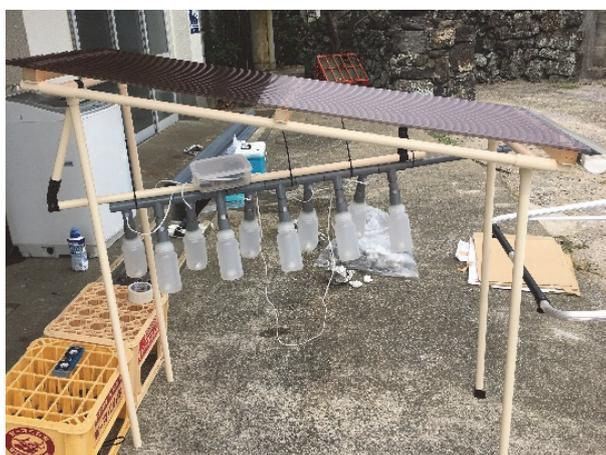
図2 自動雨水集水装置
